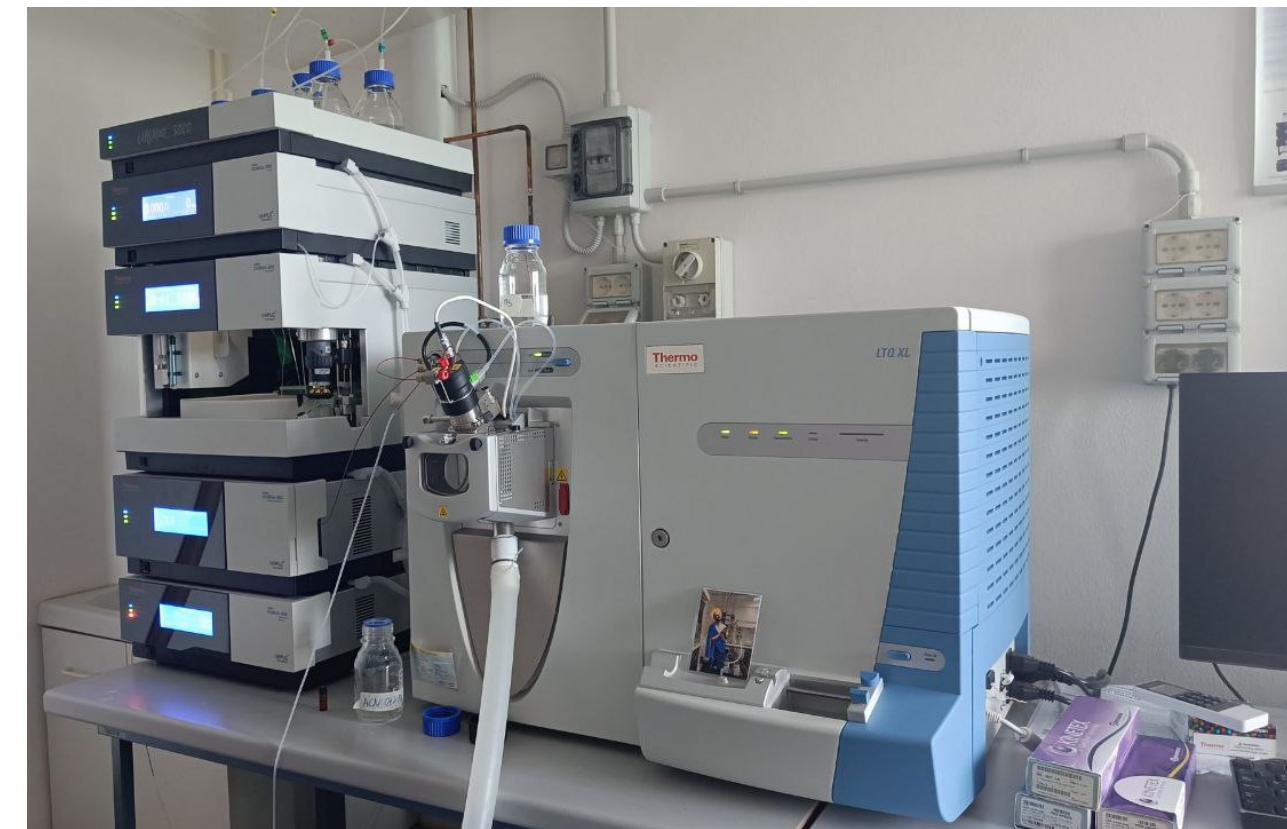
HPLC Dionex UltiMate 3000 con auto-campionatore accoppiato a Thermo Scientific LTQ XL MS
