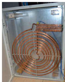
Metodi per ricarica wireless: fonte: Conductix.com (sinistra) e prototipo sviluppato (destra)
